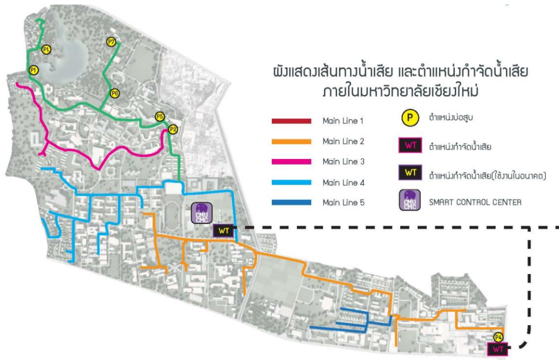
รูปที่ 2. 43 แผนผังเส้นทางน้ำเสีย และตำแหน่งกำจัดน้ำเสีย
