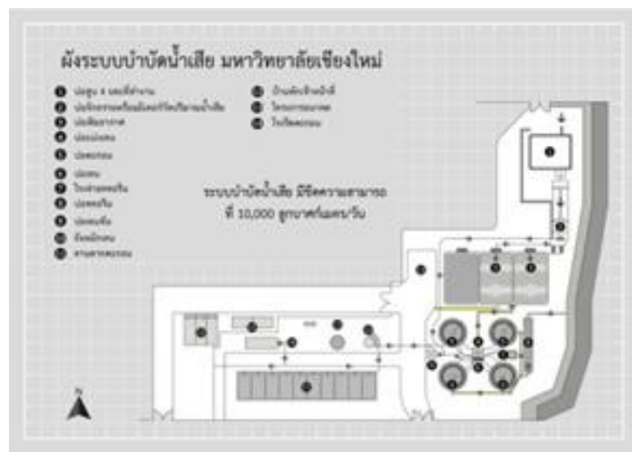
รูปที่ 2. 42 ผังระบบบำบัดน้ำเสีย มหาวิทยาลัยเชียงใหม่
